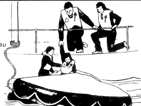
**5****Cut or untie the painter from vessel.***Couper ou défaire la drisse attachée au bateau*
